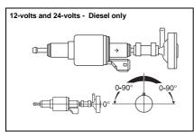
Fig. 11: Metering Pump
