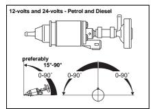
Fig. 10: Metering Pump
