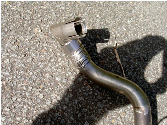
Verlängerung am Abgasrohr
